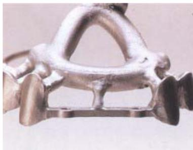
12 Потом следует паковка восковой моделировки и литье из сплава (см. Таблицу). После литья распакуйте муфель и очистите коронки пескоструйным материалом перед тем, как выполнить отделку литого объекта.
