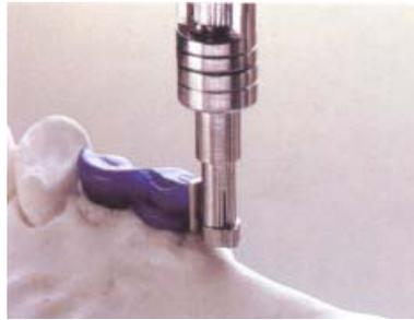
**19** После определения направления вставления приставьте матрицу держателем для обеспечения параллельности № 150 или № 250 или с помощью параллелометра.
