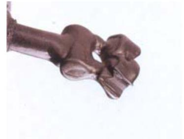
**22** После литья распакуйте муфель и очистите пескоструиванием мелкозернистым абразивным материалом коронки.
